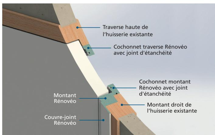
Cette solution de rénovation est simple et rapide pour poser une nouvelle porte et gagner en confort acoustique et thermique.
