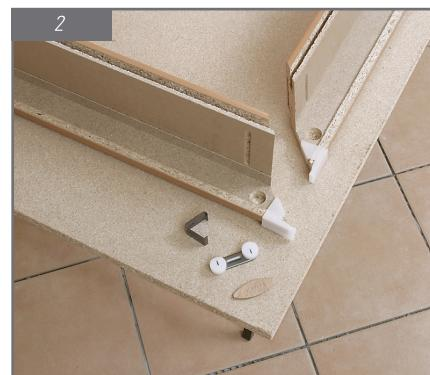
Les éléments du chambranle sont tenus par des étriers en acier (à gauche sur la photo) et des raccords d'angle excentriques (au centre) ainsi que des lamelles plates en bois.
