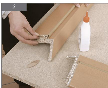
Avant d'insérer la lamelle en bois dans la fente du chambranle prévue à cet effet, appliquez de la colle à bois et assemblez les éléments.
