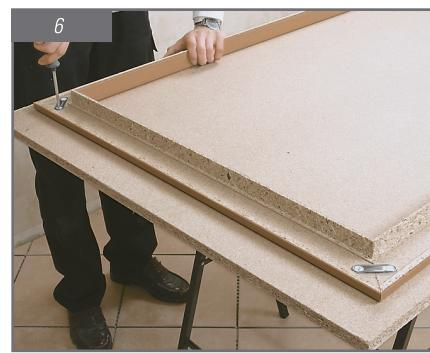
Resserrez les raccords d'angles excentriques. Assemblez ensuite l'autre partie du chambranle en répétant la même opération.
