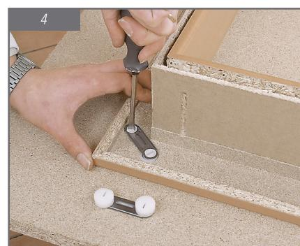
Insérez les embouts plastiques des raccords d'angle excentriques dans les emplacements prévus au dos du chambranle puis vissez.
