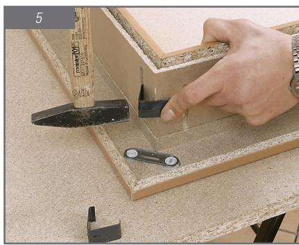
A l'aide d'un marteau, enfoncez les étriers en acier dans les rainures. Durant le serrage, vous devez maintenir les côtés finis du chambranle bien parallèles jusqu'à durcissement de la colle à bois.
