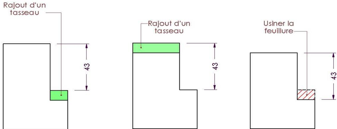
Si la profondeur est trop fine ou à l'inverse trop large, il est possible d'ajouter un tasseau (bois de densité > 450 kg/m<sup>3</sup>) ou d'usiner l'huissérie\*.
