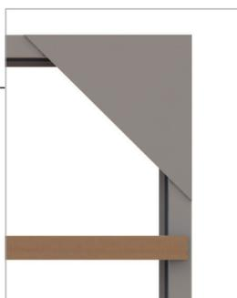
La pose d'un triangle à angle droit pointé en façade permet de maintenir l'équerrage de l'huisserie.
